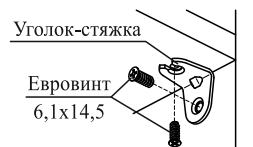
Схема 3. Установка уголка-стяжки
